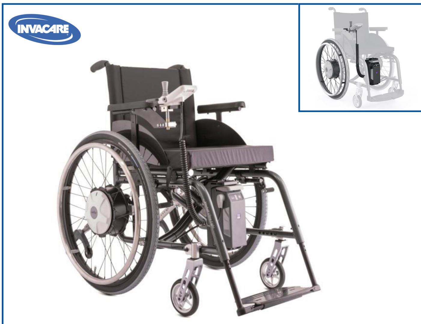
Si tratta di un dispositivo estremamente versatile che consente la trasformazione di una carrozzina manuale in elettrica mantenendone i vantaggi di trasportabilità grazie alle ruote motrici estraibili e al pacco batterie particolarmente contenuto. **La carrozzina rimane chiudibile anche con il dispositivo montato.**
